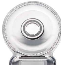
Имплант серии CI500: съемный магнит внутри предназначенного для него кармана
