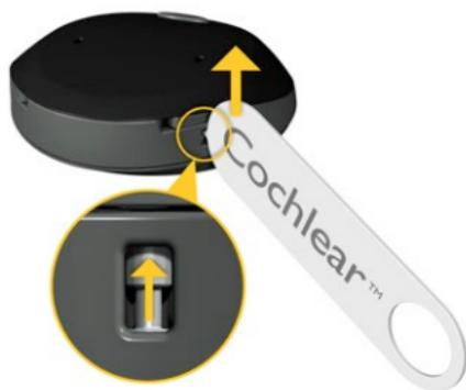
Zum Entriegeln des Batteriefachs stecken Sie das Werkzeug für Batteriefachverriegelung in den Schlitz des Batteriefachs. Schieben Sie den Arretierstift nach unten.
