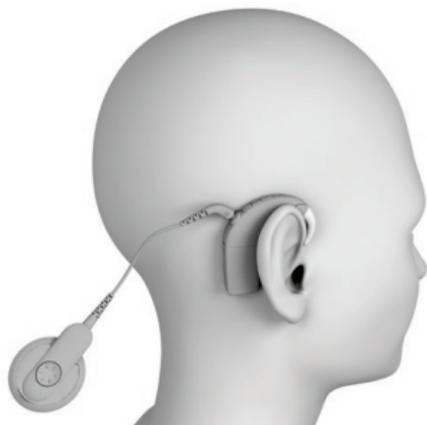
1. Coloque el procesador de sonido en la oreja, de forma que la bobina quede colgando.
