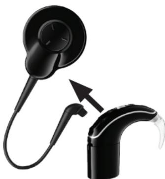
1. Greifen Sie den Stecker des Spulenkabels und **ziehen Sie ihn gerade** aus der Soundprozessor-Einheit heraus. Ziehen Sie nicht am flexiblen Teil des Spulenkabels.
