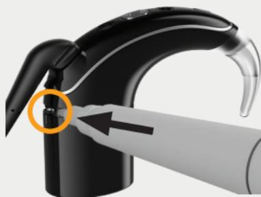
1. Schieben Sie den Verriegelungshebel bis zum Anschlag nach links, um das Batterie-/Akkumodul zu verriegeln.
