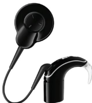
Wenn Sie ein Batteriemodul statt eines Akkumoduls nutzen oder wenn Sie die Soundprozessor-Einheit zusammen mit einer im Ohr getragenen Akustikkomponente verwenden, ist sie vor Schäden durch Staub und Spritzwasser geschützt (Schutzart IP54).
