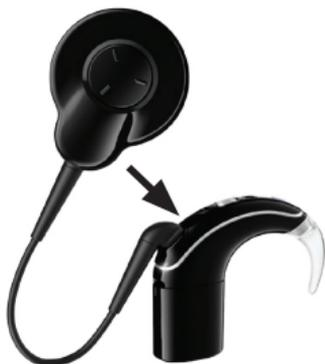
3. Schieben Sie den Stecker des Spulenkabels in die Soundprozessor-Einheit, bis er einrastet. **Verdrehen Sie den Stecker dabei nicht.**
