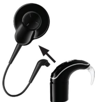
1. Greifen Sie den Stecker des Spulenkabels und **ziehen Sie ihn gerade** aus der Soundprozessor-Einheit heraus. Ziehen Sie nicht am flexiblen Teil des Spulenkabels.
