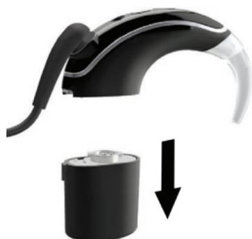
2. Halten Sie beim Wiederanschießen des Batterie-/Akkumoduls (2) die Taste (1) gedrückt.
