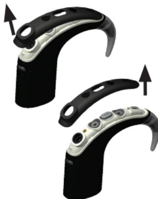
2. Heben Sie die Mikrofonabdeckung am unteren Ende an, um sie dann vollständig abzunehmen.
