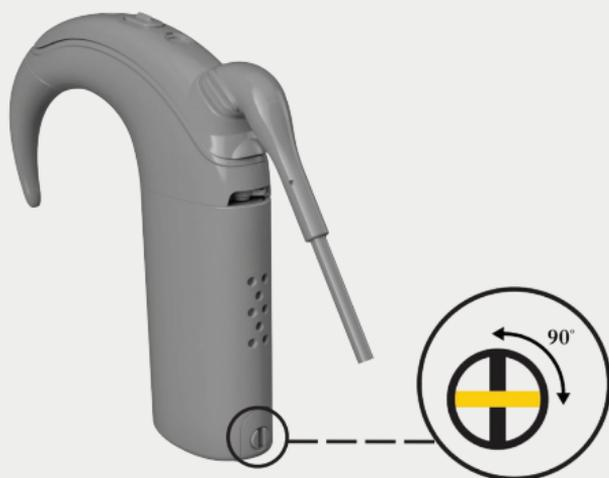
**VERRIEGELN** Drehen Sie die Sicherungsschraube mit dem Verriegelungswerkzeug **im Uhrzeigersinn**, bis sich ihr Schlitz in **waagerechter** Position befindet.
