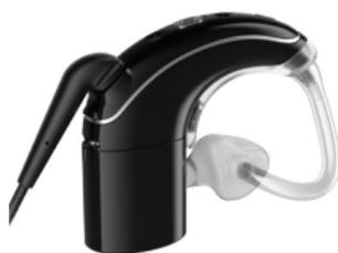
1. Entfernen Sie den Ohrhaken und das Batterie-/Akkumodul.
