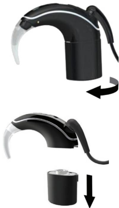
1. Drehen Sie das Batterie-/Akkumodul in der dargestellten Richtung, um es von der Soundprozessor-Einheit zu lösen.
