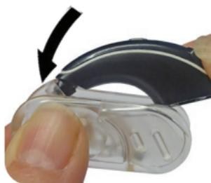
3. Drücken Sie am oberen Ende der Soundprozessor-Einheit beim Anbringen des Batterie-/ Akkumoduls nach unten, um sicherzustellen, dass die Metalllasche am Koala Clip fest im Gehäuse der Soundprozessor-Einheit sitzt.
