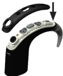
1. Setzen Sie die Mikrofonabdeckung auf die Soundprozessor-Einheit.
