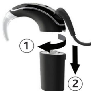
1. Drehen Sie das Batterie-/Akkumodul, um die Verbindung zu lösen, und nehmen Sie es ab.
