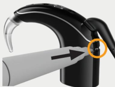
2. Schieben Sie den Verriegelungshebel bis zum Anschlag nach rechts, um das Batterie-/Akkumodul zu entriegeln.
