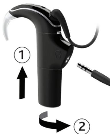
3. Setzen Sie das Batterie-/ Akkumodul ein und drehen Sie es, um es anzuschließen.
