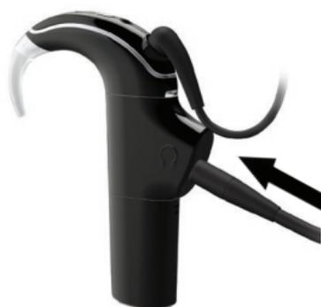
4. Schließen Sie den Kopfhörer an den Kontrollkopfhörer-Adapter an.
