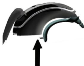
3. Bringen Sie das Batterie-/Akkumodul an und befestigen Sie die Otoplastik.
