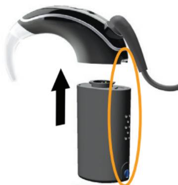
2. Drehen Sie das Batterie-/Akkumodul in der dargestellten Richtung, um es fest mit dem Soundprozessor zu verbinden.
