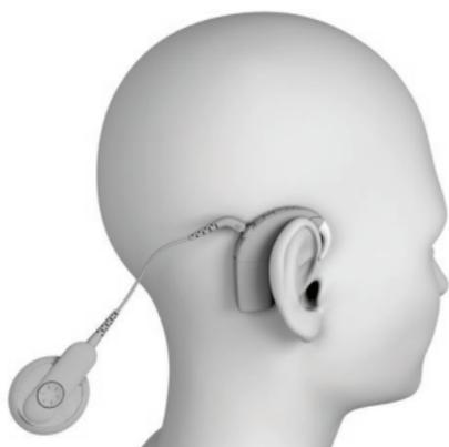
1. Setzen Sie den Soundprozessor hinter Ihr Ohr. Lassen Sie die Spule zunächst lose herabhängen.
