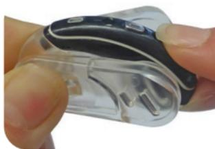
Richten Sie den Soundprozessor so aus, dass er wie beim Tragen hinter dem Ohr ausgerichtet ist.
