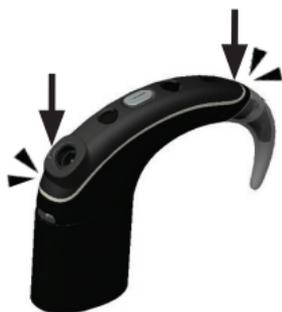
2. Drücken Sie die Mikrofonabdeckung an beiden Enden fest mit einem Finger nach unten, bis Sie ein Klicken spüren.
