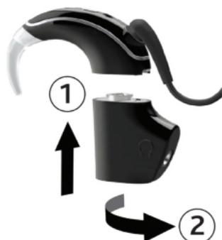
2. Setzen Sie den Kontrollkopfhörer-Adapter ein und drehen Sie ihn, um ihn anzuschließen.
