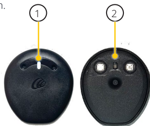
1. LED-Linse in der Mikrofonabdeckung 2. Soundprozessor LED-Anzeige
