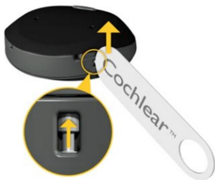
Para desbloquear la tapa de la pila, coloque la herramienta de bloqueo en la ranura de la tapa. Deslice hacia abajo el pasador de bloqueo para colocarlo en su lugar.
