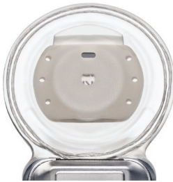
Piastra della bobina dell'impianto serie CI600 con cassetta del magnete nella tasca
