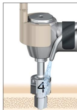
Fig. 16 : Fraisage avec fraise foret
